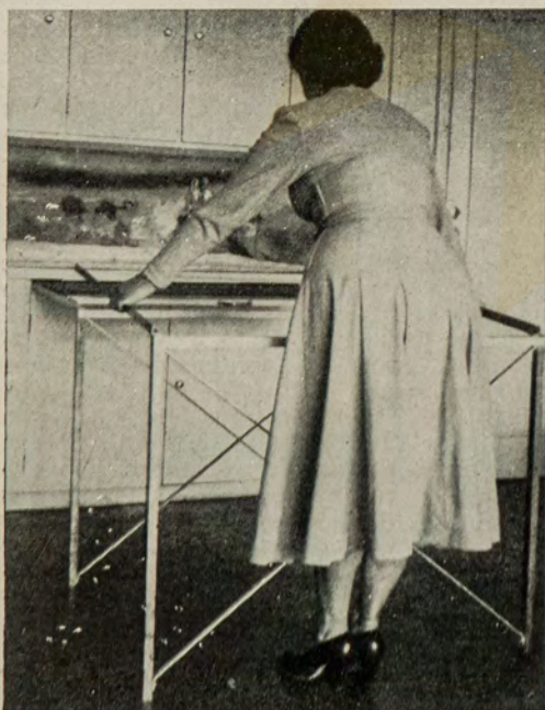
Ação de puxar o tampo, formado por uma esteira de madeira, sobre dois quadros fixados no piso e presos entre si
