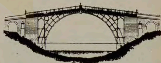
Ponte de Coalbrookdale, ou Ironbridge, sobre o rio Severn, na Inglaterra (1775-79) primeira ponte de ferro no mundo. Projeto do arquiteto Thomas F. Pritchard, sob conselho do metalurgista John Wilkinson, fundida nas usinas de Abraham Darby III. Vão livre de 32,62 m. Desenho inspirado no trabalho da madeira (Foto do livro “The Architecture of Bridges”, de Elizabeth B. Mock).
