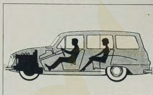
5 — Tração dianteira — centro de gravidade igual ao do carro de passageiros, proporcionando completo domínio nas curvas, maior segurança e facilidade no guiar!
