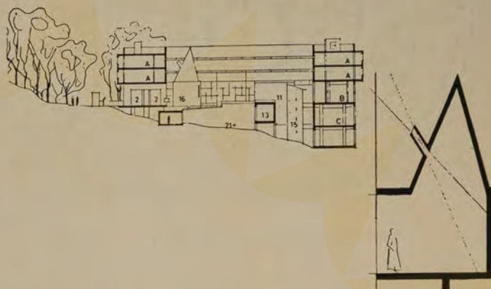
Corte transversal do Convento de La Tourette. A — Salas. B — Aula. C — Refeitório. 2 — Locutório. 11 — Átrio. 13 — Corredor coberto. 15 — Escadaria. 16 — Capela. 21 — Pátio.
