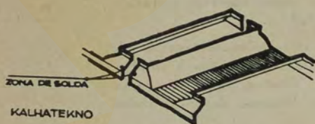
A cobertura do Plenário em perfis pré-moldados de Kalhatekno.
