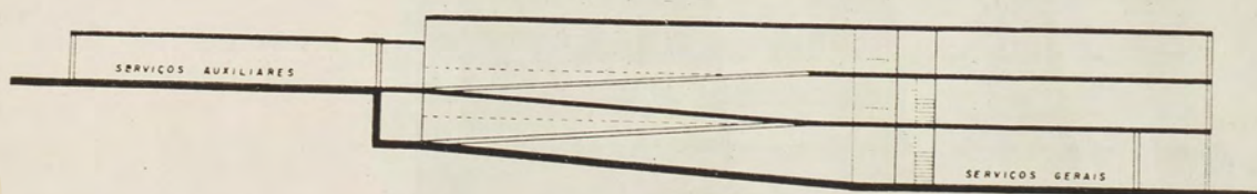
Corte esquemático pelas unidades de enfermagem — duas unidades de enfermagem de 34 leitos por pavilhão, acesso por meio de rampas.
