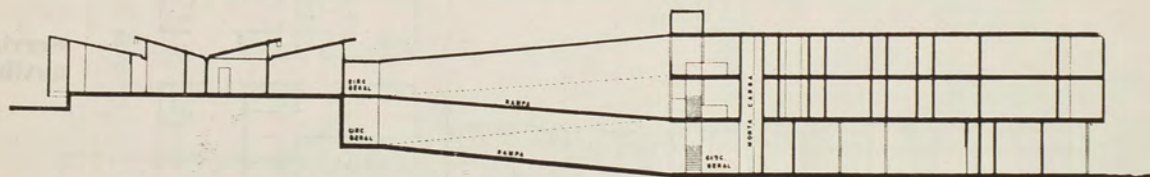
Corte exato pelo pavilhão de enfermagem, demonstra a iluminação e ventilação das dependências do pavimento térreo.
